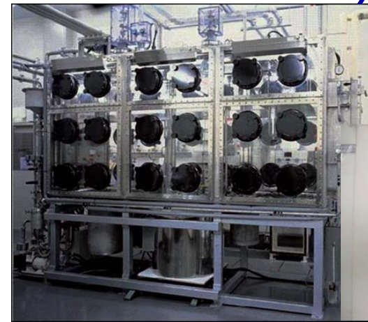
高純度Ar雰囲気グローブボックス(既設改造)
