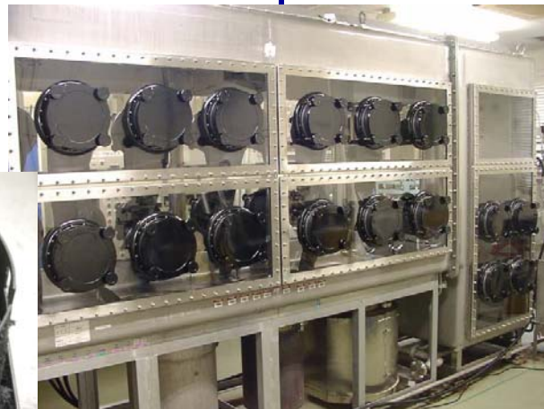
高純度Ar雰囲気グローブボックス(既設)
